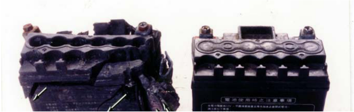
Figure 2 : Vue de la batterie de Vae impliquée dans le scénario accidentel (à gauche) et d'une batterie similaire intacte
